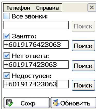
**Call Divert/Переадресация** звонков позволяет переадресовать входящие звонки на другой телефонный номер. Отмечая нужные поля, Вы можете настроить переадресацию на указываемые номера.
